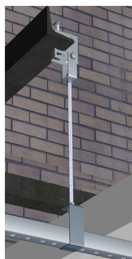
08 DETALHE FIXAÇÃO PERFILADO SEM ESCALA
